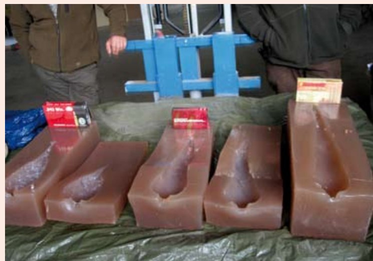
Darstellung der Geschosswirkung im Seifenblock
